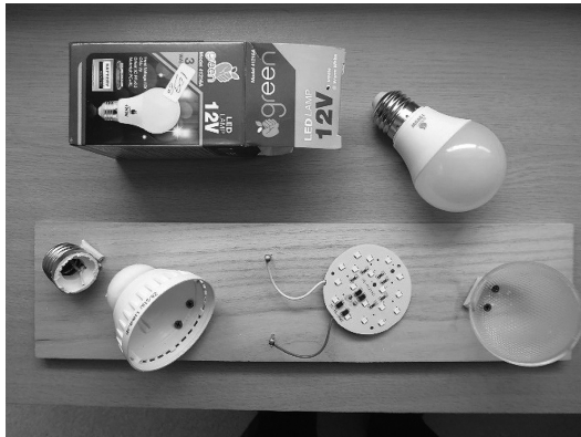
写真 1. 現地のアユタヤで購入した 12 V LED 電球の分解と点灯実験 [12 V LED 電球]
